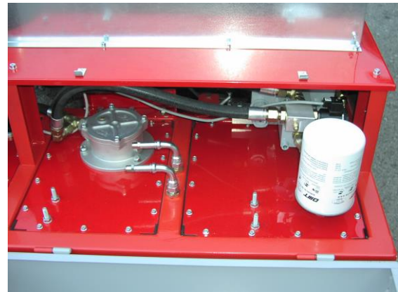
Rückansicht der Maschine mit dem Luftfilter und den Kaltwasseranschlüssen.
