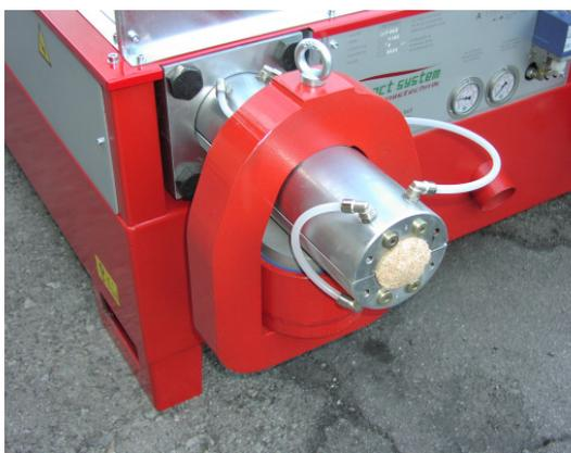
Morsa di robusta costruzione in acciaio di forte spessore garantisce bricchetti compatti.
