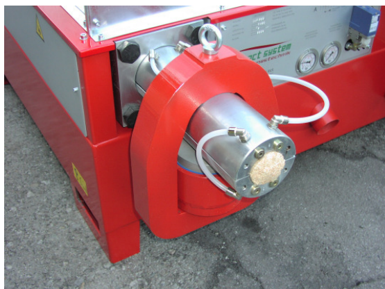
Die stabile Presszange mit starkem Zangenrohr für kompakte Briketts und lange Lebensdauer
